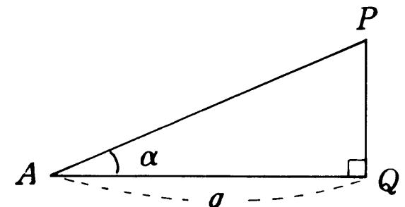
1. 設  $A$  為觀測點， $Q$  為基底，欲求  $\overline{PQ}$
