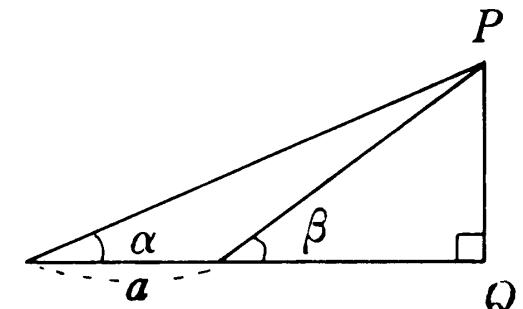
1. 設  $A$  為觀測點， $Q$  為基底，欲求  $\overline{PQ}$
