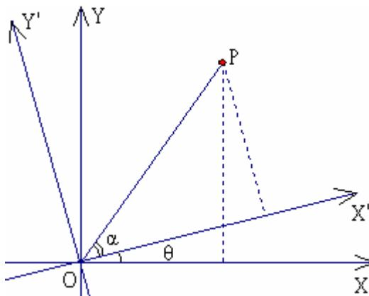
如圖，將座標軸順時針旋轉  $\theta$  度，產生一新的座標系  $X' - Y'$ ，若一  $P$  點在原座標系中之座標為  $(x, y)$ ，在新的座標系中之座標為  $(x', y')$ ，則
